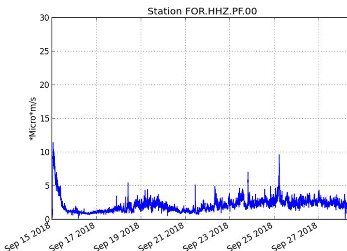
**Figure 1** : Evolution du RSAM (indicateur du trémor volcanique et de l'intensité de l'éruption) entre 04h00 (00h UTC) le 15 septembre et 16h00 (12h00 UTC) le 28 septembre sur la station sismique FOR, localisée à proximité du cratère Château Fort (2000 m d'altitude sur le flanc sud-est du cône terminal).
