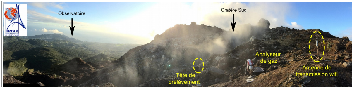
Sommet de la Soufrière. Installation d'un analyseur de gaz (MultiGaz) au niveau de la fumerolle du Cratère Sud © J.C. Komorowski-IPGP.
