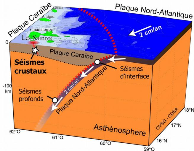
**Figure 2** : Schéma simplifié de la subduction active aux Antilles avec les différents types de séismes tectoniques possibles. Le séisme du 21 novembre 2004 ainsi que toutes ses répliques résultent de la déformation de la plaque Caraïbe (séismes crustaux). La faille de Roseau (en rouge) a rompu lors du séisme principal (voir Figure 3).
